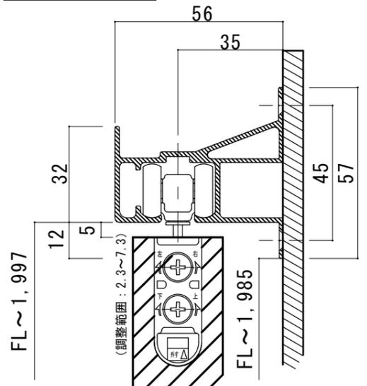
レール下端が床から1,985mmに取り付けて下さい。
