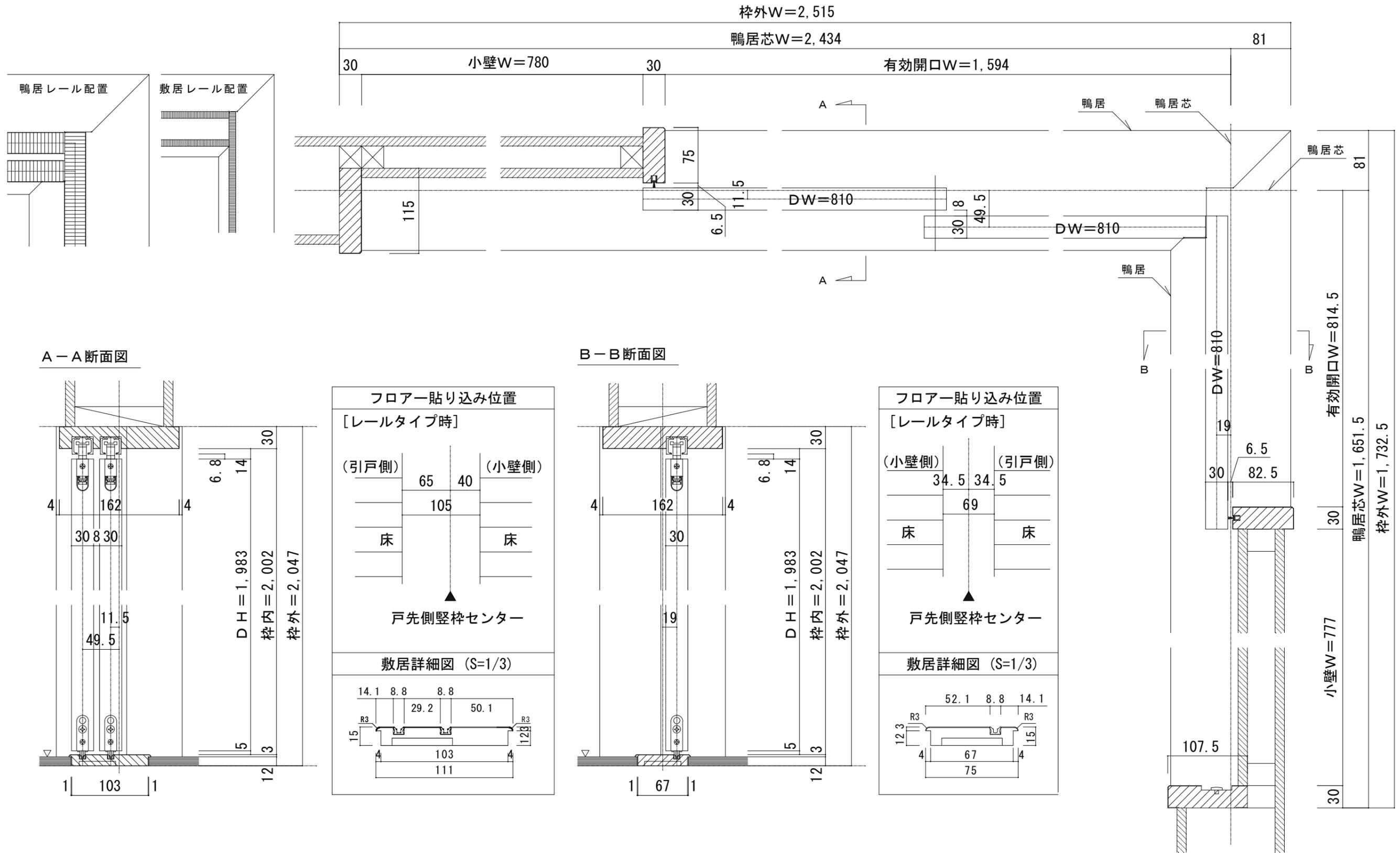
ドレタス L字開口納まり枠セット レールタイプ 固定枠 敷居Q型
