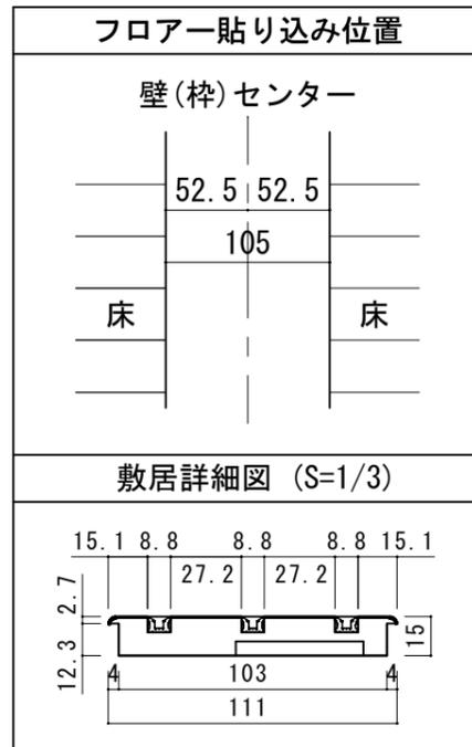
■縦断面図 [床直付けレールタイプ]
