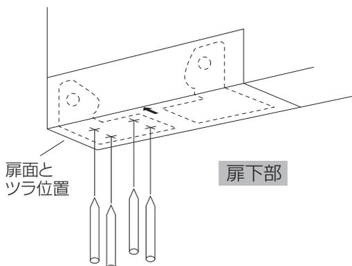
扉 丁番下穴位置の治具は左右共通になっています。(図のように「山折り」部を折ってご使用ください。) 治具は扉面にツラ位置に合わせ印のセンター位置にポンチ等で下穴位置をつけてください。その下穴に従って丁番を付属のビスでお取り付けください。
