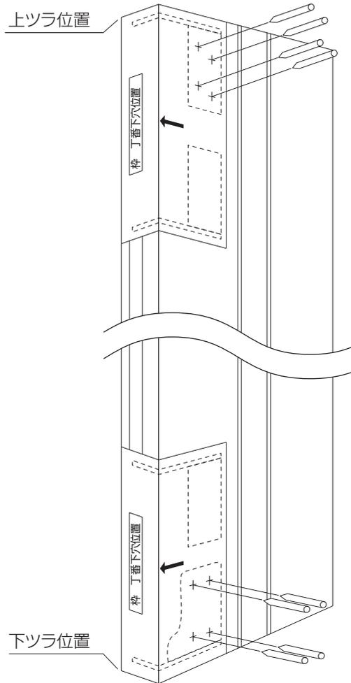
枠 丁番下穴位置の治具は1枚に上部金具と下部金具が印刷されています。上部金具の場合、治具を天井面に付けてください。
