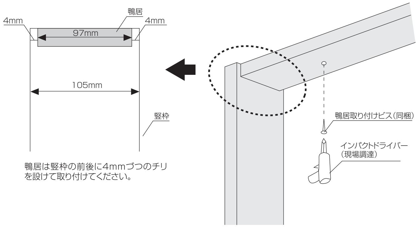
鴨居のビス取り付け穴(加工済)から同梱の鴨居取り付けビスで固定してください。
