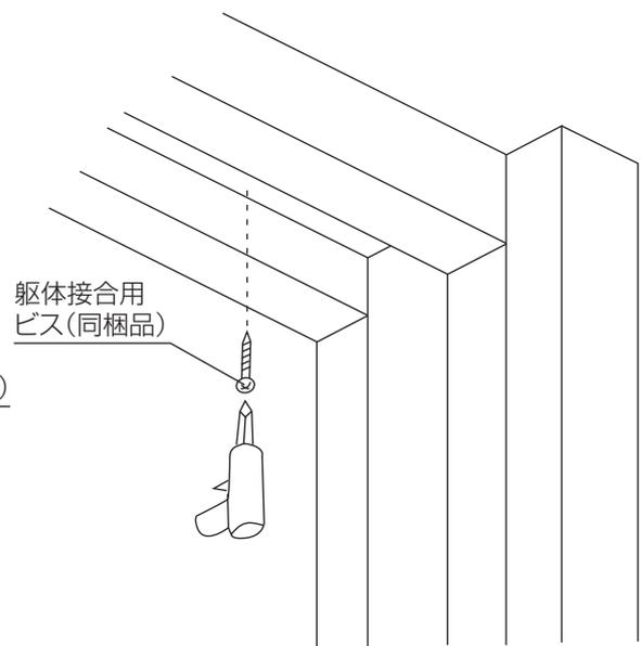
レールを取り付ける前に必ず鴨居本体を躯体に固定させてください。
