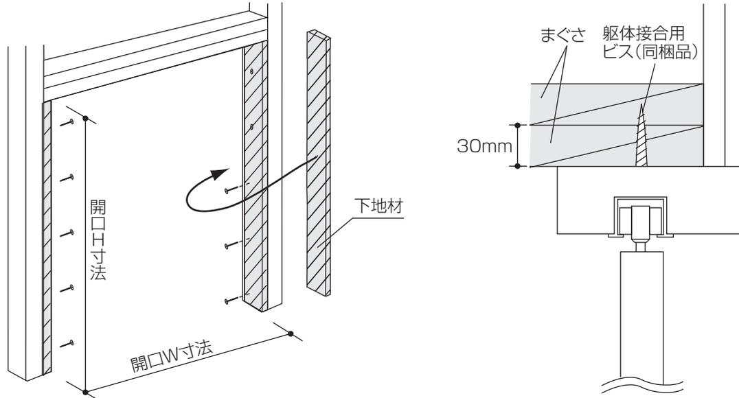
開口部に下地材を取り付け、納まり図参照の上、枠外寸法に見合った開口を設けてください。
