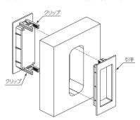
樹脂製ワンタッチは引手の取り付け向きを確認後セットし、浮 いた状態にならないよう、しっかりと扉面に押さえて下さい。
