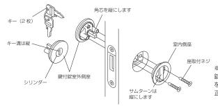
※間什切錠・表示錠・両側サムターン 錠・鍵付錠のいずれも取付後は、引戸 を開けたまま、サムターン・キーで鍵が 正しく動作することをご確認下さい。
