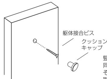
縦枠は誘導穴のところから同梱のビスで固定し、その上にクッションキャップを取り付けてください。
