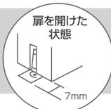
※③ 鍵有りの場合の縦枠は、「枠上」をカットし床上に施工して下さい。「枠下」はカットしないで下さい。
