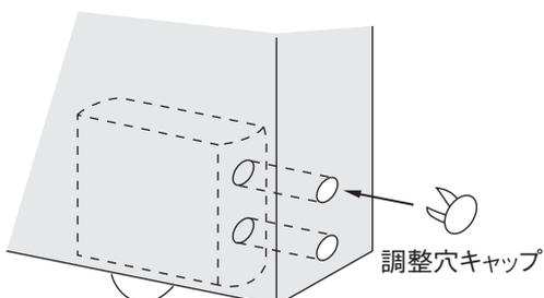
調整後は、必ず同梱の調整穴キャップの取り付けをしてください。
