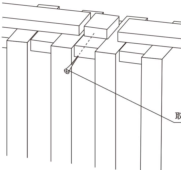
連結用上棧を取り付けビスで鴨居に固定します。
