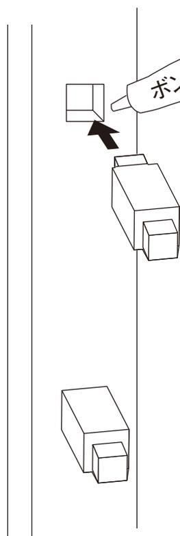
連結するスクリーンパネルのたて格子にホゾ加工をおこなないボンドを用いて連結用中棧を取り付けます。中棧が必要ない場合は取り付けをしなくても結構です。
