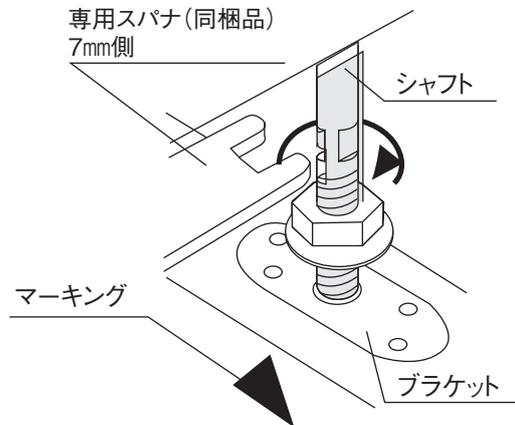
〈3〉上レール幕板と扉とのスキマが3mmになるまで吊り上げたら、専用スパナの13mm側でナットを強く締めこんでください。
