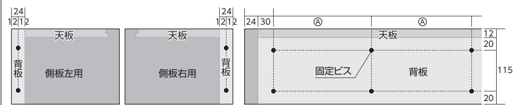
天板を前板の溝に木工用接着剤（現場調達）を塗布してからはめ込み、ビス（現場調達）で固定します。
