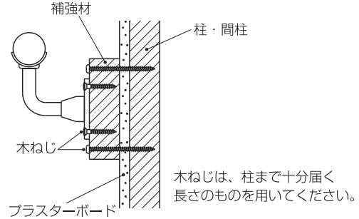
① 柱に下穴 (Φ3.0) を開けて本体をタッピンねじで取り付けてください。
