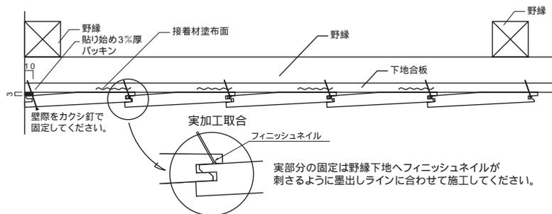
貼り始めには、3%×10%のパッキン(現場調達)を天井入隅へ取り付け天井材の角度が2枚目以降と揃うように取り付けてください。施工は天井材の天井接地面にボンド(現場調達)を施工し、壁際はカクシ釘実側はフィッシュネイルにて固定してください。
