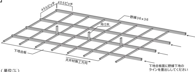
野縁は36%×36%サイズ以上を使用し、下地合板を貼ってください。下地の完成後に、天井材を固定するために、下地の位置を墨出しして、取り付けの準備をしてください。
