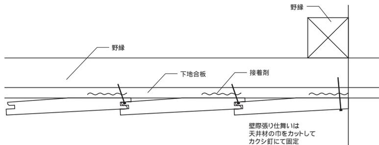
貼り仕舞いの寸法に合わせて天井材の巾をカットし、ボンド(現場調達)を施工して壁際はカクシ釘にて堅固に取り付けてください。
