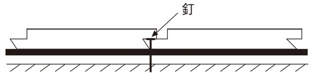
裏面へ木工用接着剤(現場調達)を塗布し、サネのかさなる部分へ釘を壁下地に向けて、打ち込んでください。(天井に使用時は、特に接着剤併用を厳守してください。)
