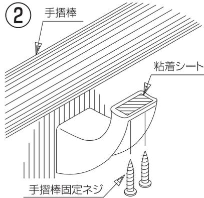
ブラケット手摺棒受部の粘着シートで手摺棒を仮固定し、手摺棒固定ネジAナベ3.5×20 2本にて手摺棒を固定します。
