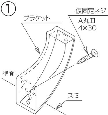
壁面にスミ出し後、スミ出しマークにあわせ仮固定ネジA丸皿4×30 1本にて仮固定します。
