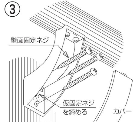
壁面に壁面固定ネジAナベ4×40 3本にてブラケットを固定し、カバーを装着します。
