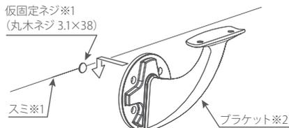
②丸棒手すり固定ネジ(丸皿 3×20)2本にて丸棒手すりを固定します。
