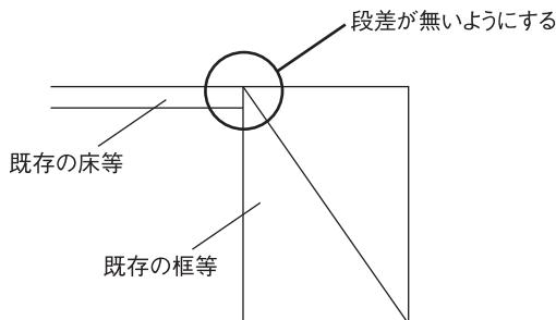
既存の上り框の上面とフロアをカンナまたはサンダーなどで削り、段差をなくして平滑にしてください。
