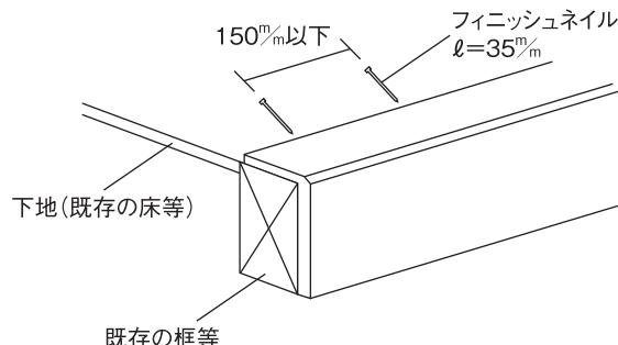
(2)6mm床材用の框は図のようにくし目ゴテを使用して専用接着剤を塗布してください。
