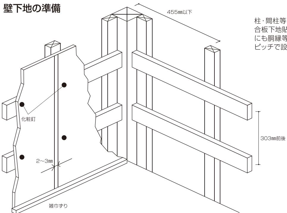
柱・間柱等を455mm以下に設置し、合板下地貼り、もしくは横方向にも胴縁等を303mm前後のピッチで設置してください。
