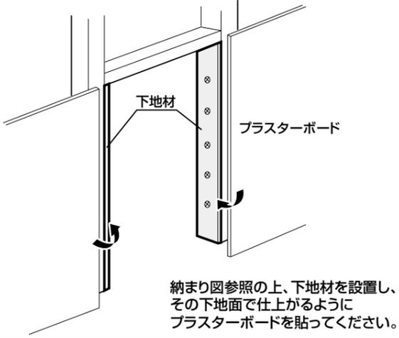
**2 枠材の組み立て** ※下図は和洋片引き戸枠のものです。
