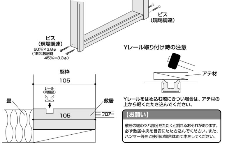
**3 枠材の仮固定と建て付け調整**
