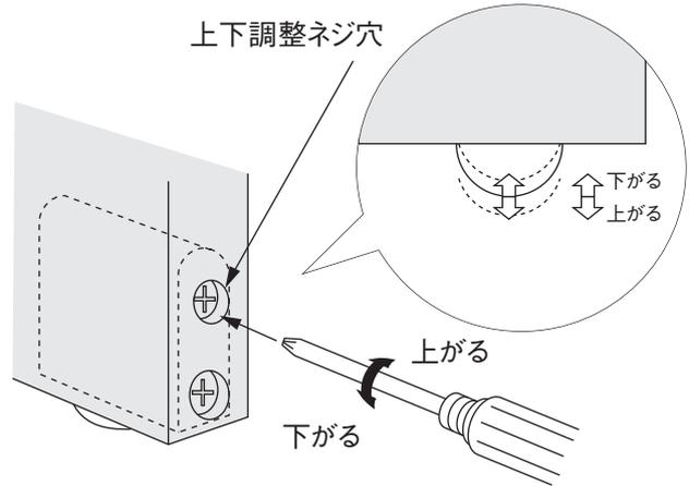
縦枠と引き戸との間に生じる隙間をよくご確認ください。
