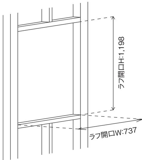
ラフ開口寸法(H:1,198mm、W:737mm)の寸法を確認してください。柱の垂直、床、まぐさの水平を下げ振り、水準器でよく確認、調整をしてください。
