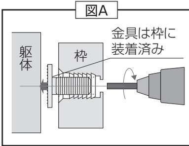
同梱のミニレンチをインパクトドライバーにチャックして、時計回りに廻し、金具の足を柱まで伸ばします。チャックできないインパクトドライバーの場合は、ミニレンチの十字にビットを差し込んでご使用ください。
