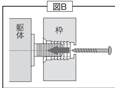
枠材表面の穴よりビスを差し込み、柱と枠を固定します。
