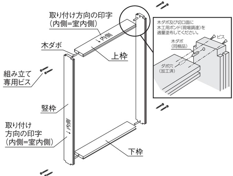
縦枠及び上枠、下枠の各部材裏面に取り付け方向が印字されています。矢印の内側が室内側となります。取り付け方向を揃えて木ダボと組み立て専用ビスで固定してください。
