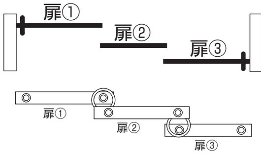
ピボットを連動金具の差し込み穴に合わせてはめ込みます。
