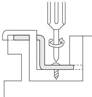
ラッチ受けの中の固定ネジを⊕ドライバーでゆるめます。
