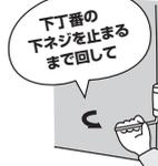
**5** 下丁番の上部調整ネジを、上から見て時計回りに回転させ、しっかりと締めつけ、固定します。
