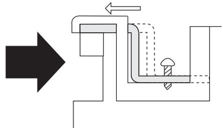
スライド板を矢印の方向に動かし、広げます。位置を確認して、固定ネジを締め、完了です。
