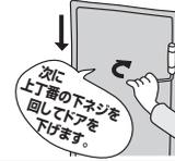
**3** 上丁番の上部調整ネジを、上から見て時計回りに回転させ、しっかりと締めつけ、固定します。
