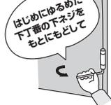
**5** 下丁番の上部調整ネジを、上から見て時計回りに回転させ、しっかりと締めつけ、固定します。
