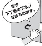
**2** ドアの上部がスムーズに動くまで、ドアと枠とのスキ間を見ながら、上丁番の下部調整ネジを、上から見て時計回りに回転させます。(ドアが少しずつさがります)
