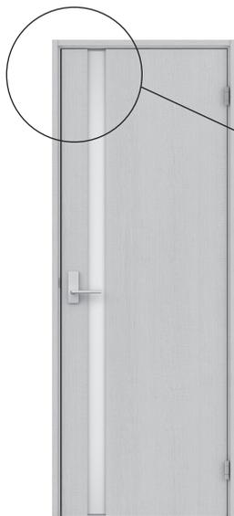
左記図のように縦2方框(ガラス)商品は8mmの合わせガラスにて框部材の接合を行っています。したがって、ガラス見付部より30ミリ以内へのドアストッパーの取り付けは、絶対しないようお願いいたします。
