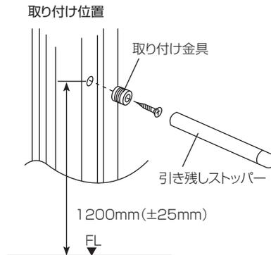
※小壁側の壁柱の防間じゃくりセンターに床から1200mm(±25mm)の高さに取り付けてください。
