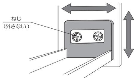
扉裏のねじ 2箇所をゆるめます。(外さない)他の扉との取り合いを見ながら調整します。(上下3ミリ・左右2ミリ調整できます。)
