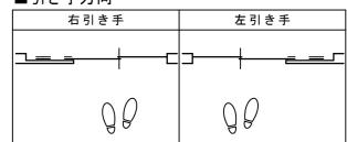
※大型サムターン表示錠使用時は、引戸引き残しストッパーを ご使用ください。ただし、有効開口は102ミリ狭くなります。 ※図示:左引き手
