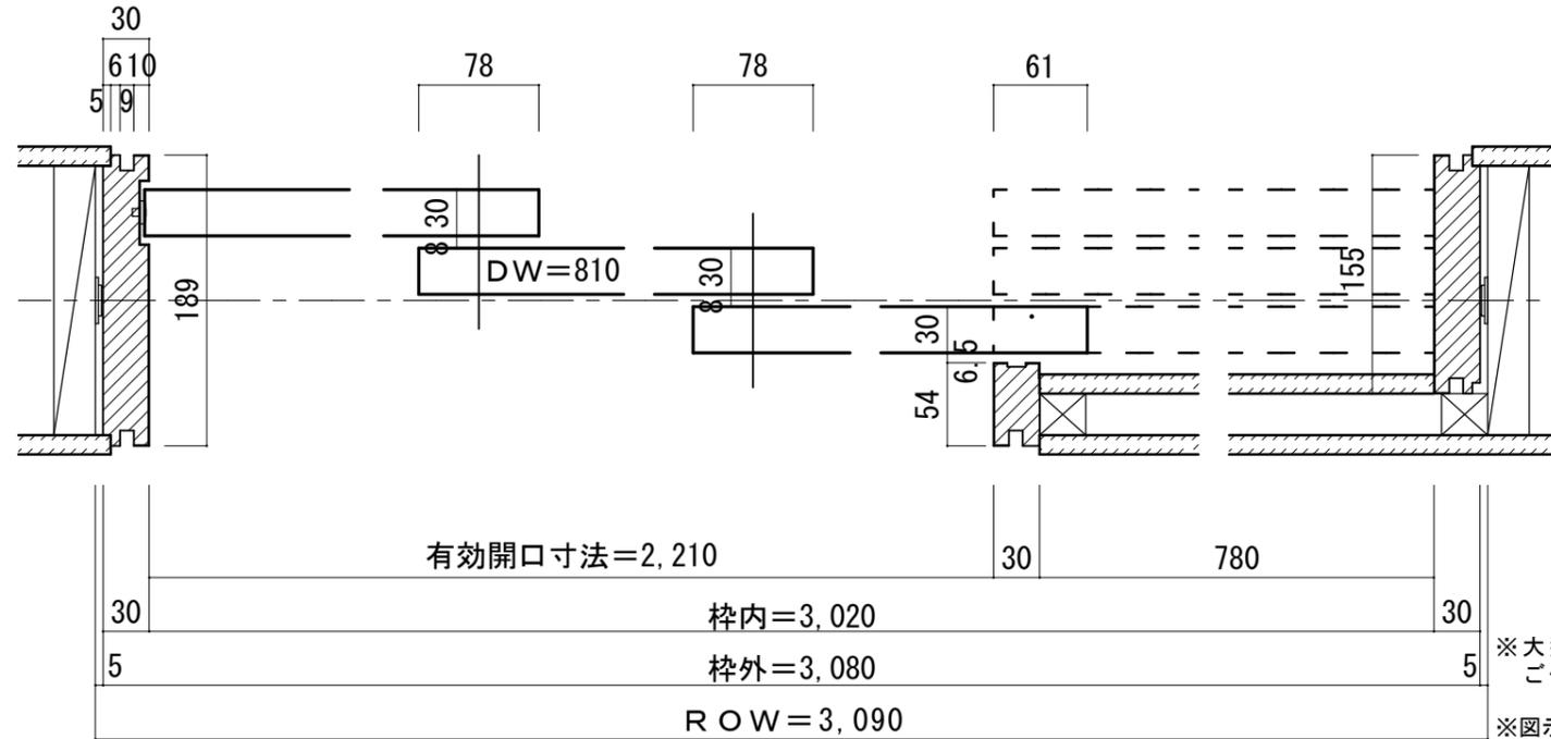
※大型サムターン表示錠使用時は、引戸引き残しストッパーをご使用ください。ただし、有効開口は102ミリ狭くなります。
