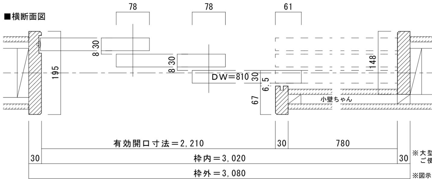
※大型サムターン表示錠使用時は、引戸引き残しストッパーをご使用ください。ただし、有効開口は102ミリ狭くなります。
