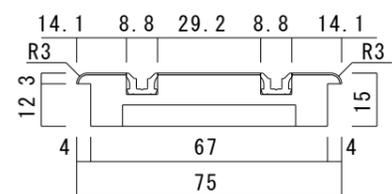
■縦断面図〔床直付けレールタイプ〕
