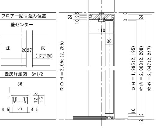
竪枠下端加工図 フロア一貼り込み位置 113 壁センター ∕-現場カット 床 (ドア側) 103.5 9. 5 ※要カスタムオーダー 敷居詳細図 S=1/2 36 33 12 4. 5 | 27 | 4. 5
