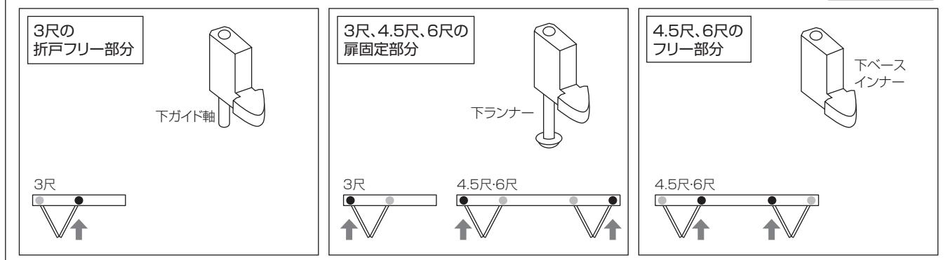
下ランナーをレールの溝に入れ、上ランナーをクローゼット扉を折り曲げて固定カップで挟み込むようにします。
