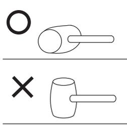
本製品は艶消し塗装仕上げになります。ゴムハンマーで表面を叩くと、その部分だけ艶が高くなる場合があるため、ゴムハンマーは側面を表面に当てる使い方(平使い)をお願いします。
