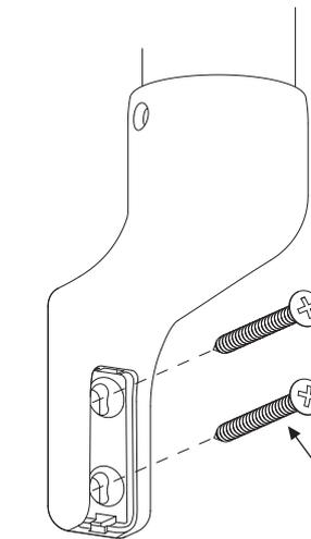
① 柱に下穴（φ3.0）を開けて本体をタッピンねじで取り付けてください。
