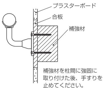
補強材を柱間に強固に取り付けた後、手すりを止めてください。
