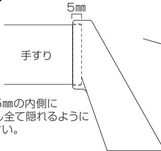
※上図のように5mmの内側にマーキングをし全て隠れるように挿入してください。
