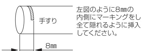
左図のように8mmの内側にマーキングをし全て隠れるように挿入してください。
