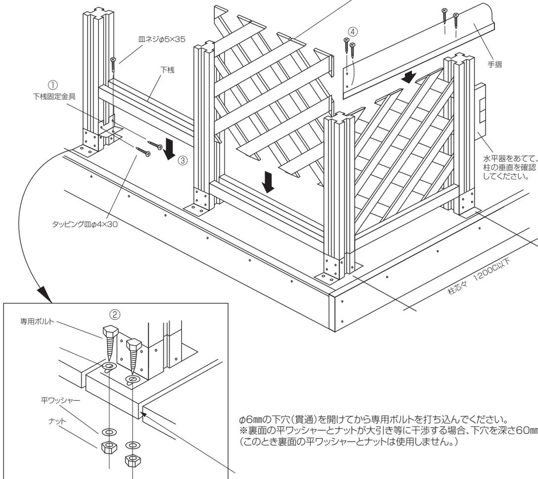
φ6mmの下穴(貫通)を開けてから専用ボルトを打ち込んでください。
