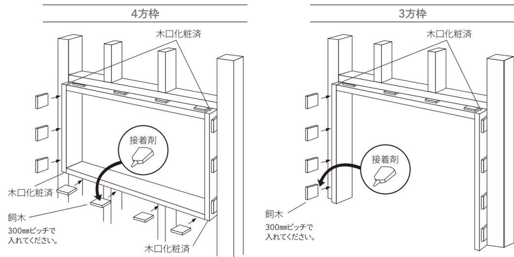
飼木(クサビ)を入れて垂直・水平・ネジレを調整し、市販の接着剤とビスで確実に固定してください。
