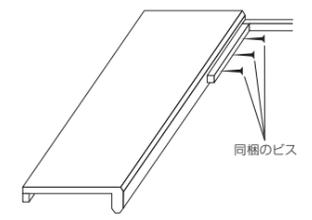
押し入れ棚板の表面より15mm下がった位置に棧木を固定します。L字コーナー&目地キャップにφ4.2×50mmのビスが3本同梱されています。
