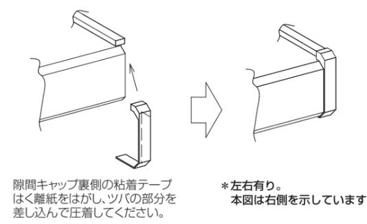
隙間キャップ裏側の粘着テープはく離紙をはがし、ツバの部分差し込んで圧着してください。
