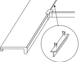
目地キャップを必要な長さにカットします。目地キャップをウレタン系接着剤(現地調達)を塗布した溝にセットしてください。必要に応じて、長さ30~40mmのカラーネイル(現地調達)で固定してください。
