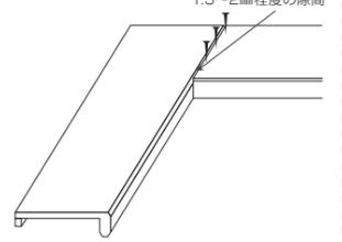
棧木に木工用ボンド(現地調達)を塗り、目地キャップを差し込める程度隙間を空け、棚板をセットし、目地キャップで隠れる位置にネイルで固定します。
