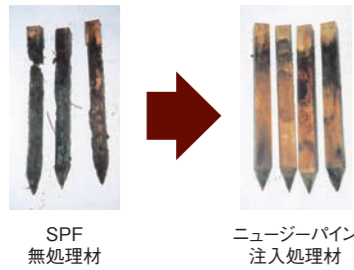
ニュージーパイン®を防腐防蟻処理したウッドデッキ製品。野外杭試験で従来のSPF(スプルース・パイン・ファーの総称)材よりも高い耐久性が確認されました。
