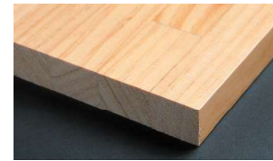
■集成材 ひき板や小角材などを集成接着した、応用力豊かな建材。
