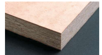
■トライウッド® 繊維板を中質繊維板で挟んだ三層構造は、内装材に最適。
