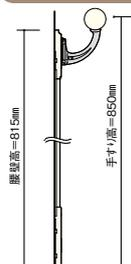
パネル上部の横見切りには丸型手すりのブラケットが取り付け可能。より安全な住まいづくりのために、手すりの設置をご提案します。
