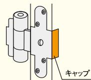
ドア側丁番のキャップです。差し込み口の反対側の木口に仕上げとして使用します。
