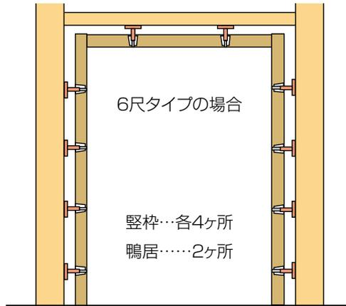
取り付け調整 施工時間短縮、手間軽減、調整はドライバー1本でOK!
