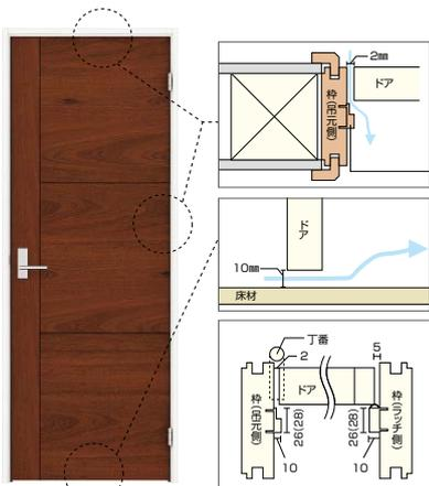
4方枠(下枠付)専用枠材に
