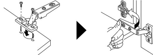
ヒンジを扉の下穴に押し込みビス止めします。
