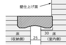
※15mmフローアご使用の際は、3mmのベニヤ板を下地にしたうえで施工してください。
