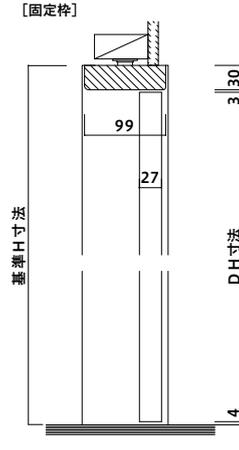
※注意:3方枠の場合は、縦枠の下端を15mm現場カットしてください。
