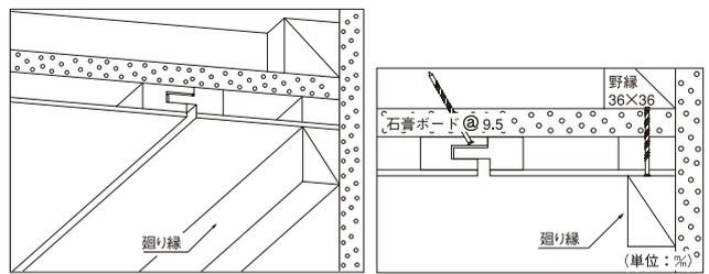
メリザネの固定と張り仕舞で取り付けた壁際部分固定用のスクリーュー釘が隠れるように廻り縁を取り付けてください。
