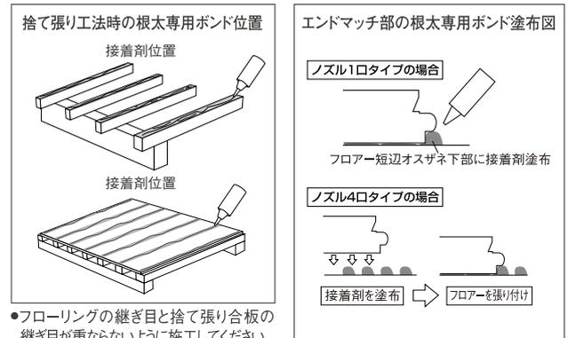
●フローリングの継ぎ目と捨て張り合板の継ぎ目が重ならないように施工してください。
