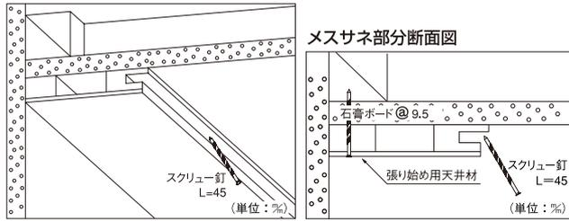
天井材メスサネ部分を [メスサネ部分断面図] を参考に、45%ピッチでスクリーュー釘を使用し野縁へ固定します。
