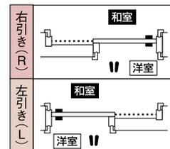
図のように洋側から見て、引き手が右側にある場合を「右引き」、引き手が左側にある場合を「左引き」としています。引き手の左右をご確認の上、発注ください。
