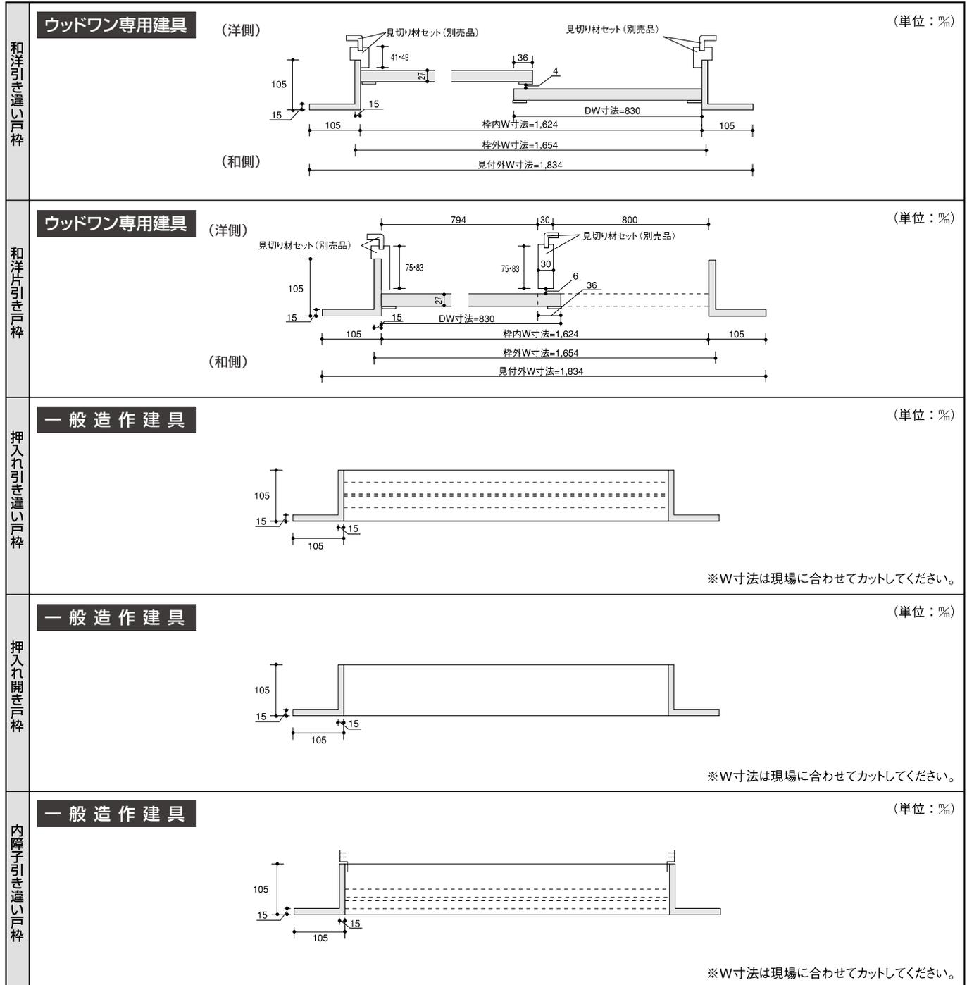
※和洋引き戸枠の納まり図は襖縁(現場調達)を含んだ寸法図としています。
