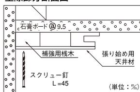
石膏ボード捨て張り下地の場合、天井材の施工はスクリュー釘を使用し施工を行います。張り始め用にカットした天井材の壁際部分を[壁際部分断面図]を参考に、910%ピッチ以内で天井材表面よりスクリュー釘を使用し野縁へ固定します。
