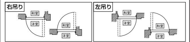
※和洋シングルドア (戸襖) と戸襖錠セットのR・Lは、ドアを洋室 (廊下側) から見て右吊元=R、左吊元=Lとしています。
