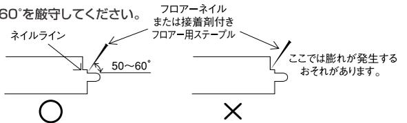
※ネイルラインのない商品はオスザネ上部の根元に同角度で打ち込み膨れが発生しないよう、特に注意して施工してください。
