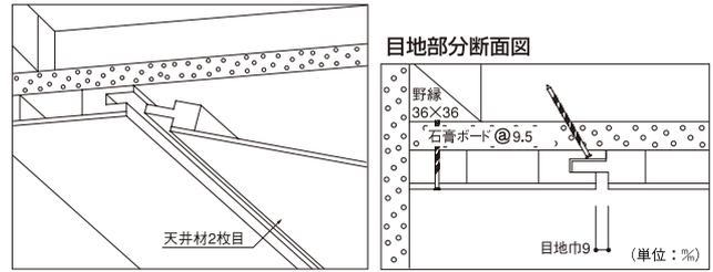
2枚目に施工する天井材のオスサネ部分を、事前に固定してある天井材メスサネ部分に目地巾が9%になるまで差し込み、1枚目同様にメスサネ部分よりスクリーュー釘で野縁に固定してください。
