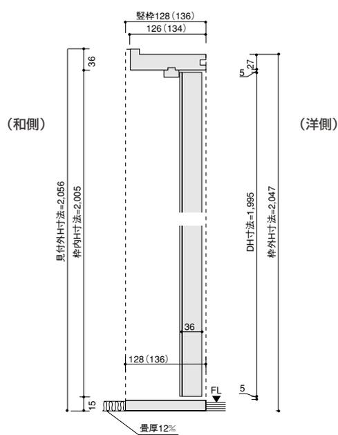
※上記納まり図は襖縁（現場調達）を含んだ寸法図としています。 ※上記納まり図は気密仕様となります。 ※（ ）内は柱120%内胴縁・柱105%外胴縁用のものです。
