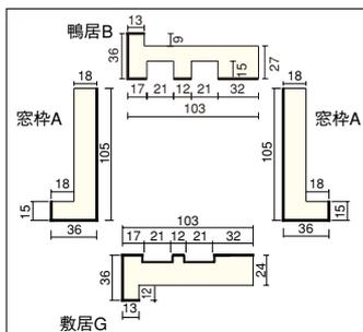
●在来工法用 (窓枠巾120<sup>mm</sup>用) 寸法図 (mm)
