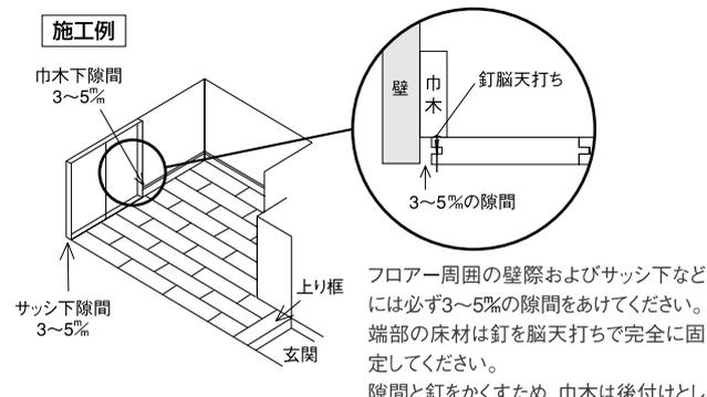
フロー周囲の壁際およびサッシ下などには必ず3〜5%の隙間をあけてください。端部の床材は釘を脳天打ちで完全に固定してください。隙間と釘をかくすため、巾木は後付けとしてください。
