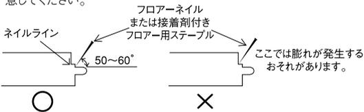
※フローア周辺の壁際およびサッシ下などには必ず3~5%の隙間をあけてください。また端部の床材は脳天から釘打ちし、完全に固定させてください。
