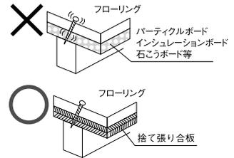
**注意** 無垢フローリングの場合：捨て張り専用床材ですので、直接根太上に施工すると強度不足のため破損することがありますので、必ず根太上に厚さ12%以上の合板を捨て張りして施工してください。
