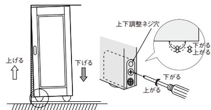
縦枠と引き戸の間に生じる隙間をよくご確認ください。
