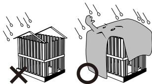
2. 下地材 (捨て張り合板) は含水率14%以下、床下 (コンクリート) 等はコンクリート含水計において含水率10%以下になるまで十分に乾燥させ、ご確認後に施工してください。含水率が高いと接着不良や床材の反り、突き上げ、変色等が生じるおそれがあります。
