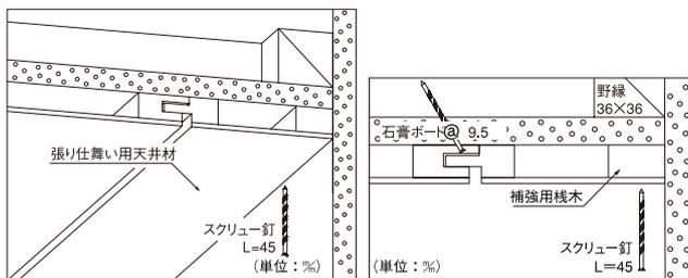
天井材の長さ方向・巾方向のカットで張り仕舞用にカットした天井材も同様に、オスサネ部分を事前に固定してある天井材メスサネ部分に目地巾が9%になるまで差し込みます。
