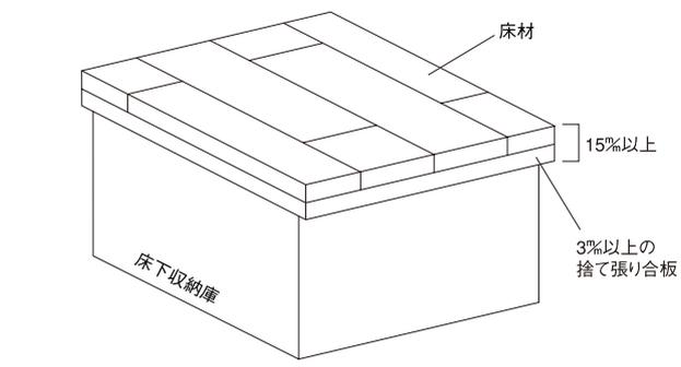
**注意** フローを床下収納庫の天板に使用する場合、製品厚15%未満のものは荷重による破損の危険性がありますので、捨て張り合板を使用し、総厚が15%以上になるようにしてください。
