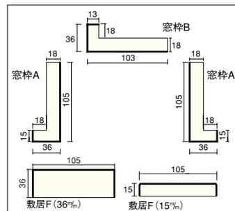
●在来工法用(桧枠巾120%用)寸法図(%)
