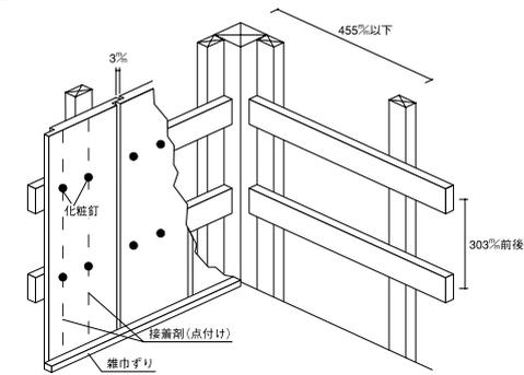
柱・間柱等を455mm以下に設置し、合板下地貼り、もしくは横方向にも胴縁等を303mm前後のピッチで設置してください。
