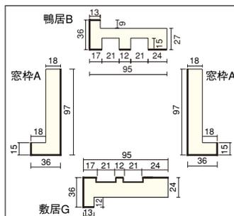
●正寸プレカット対応寸法図 (mm)
