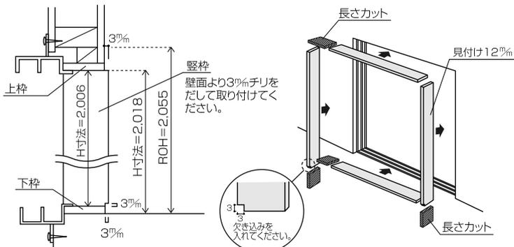
※開口枠納まりにつきましては横がち納まりとなります。※W寸法は納まり図集を参照してください。
