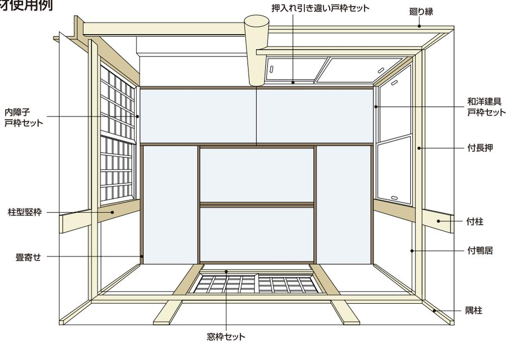
■造作部材は二重構造。後付施工で美しい仕上がりを実現。
