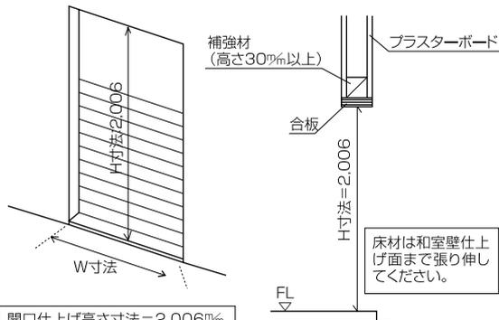
開口仕上げ高さ寸法=2,006mmで仕上げてください。W寸法=納まり図を参照してください。
