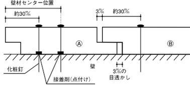
・左図のように壁材に3%の目透かしを取り、下地材に合わせて化粧釘と接着剤(点付け)で施工してください。壁材Bの継ぎ手から30%程のところ、前の壁材Aを押しやるようにして化粧釘を打ってください。
