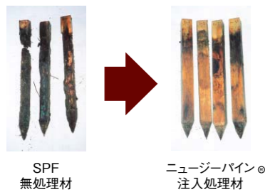
ニュージーパイン ® を防腐防蟻処理したウッドデッキ製品。野外杭試験で従来のSPF(スプルース・パイン・ファーの総称)材よりも高い耐久性が確認されました。
